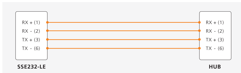
Figura 5 - Esquema de Cable No cruzado
