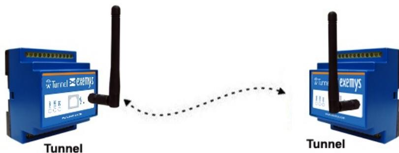
El dispositivo básicamente permite realizar un espejo de las entradas / salidas y puerto serie de un equipo al otro, esto quiere decir que si excitamos por ejemplo la entrada digital 1 en un equipo veremos reflejado el accionamiento de la salida digital 1 en el otro.
