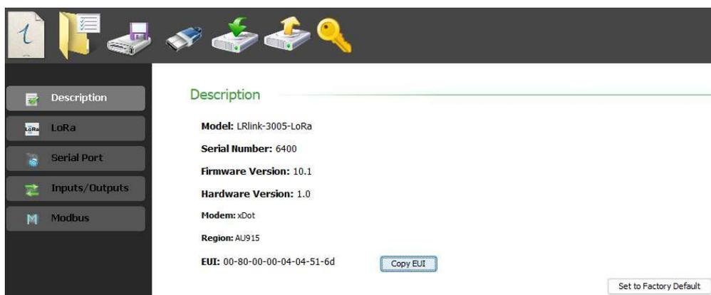
Modelo del equipo, Número de serie, Versión Firmware, Versión de Hardware, Tipo de Modem LoRa, Región y EUI (solo se muestra si el LoRa) esta Activado.
