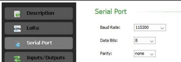
En este Menú se configura *Baud Rate*, *Data Bits* y Paridad.
